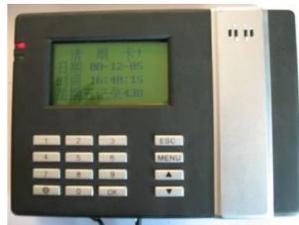
**一套配置：**DC12 电源、控制器、485 通讯器、IC 发卡读卡器、12V 锁、开门按钮、闭门器、卡、软件几部分组成。
